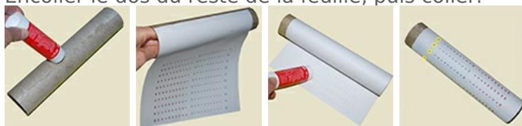
Enrouler la sur grille autour du cylindre , positionner les deux cases de lectures sur deux nombres d'une même colonne pour bien la positionner. Plier le surplus de papier de la sur grille (juste avant les cases de lecture . Découper le long du pli. Repositionner la sur grille autour du cylindre toujours en veillant de bien positionner les cases de lecture puis coller l'une sur l'autre les extrémités de la sur grille.
